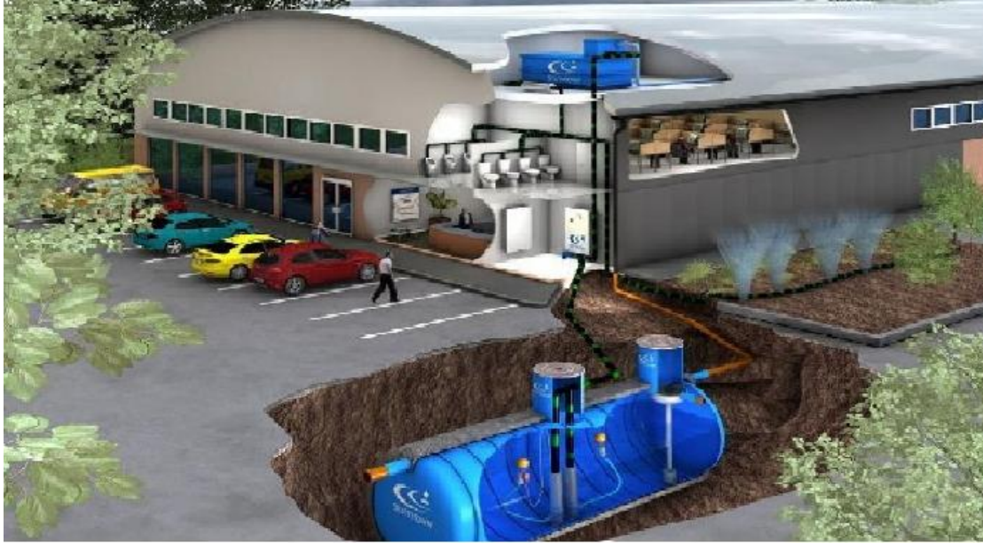
شكل رقم (4) : نموذج لنظام حصاد مياه المستجمعات الصغيرة
