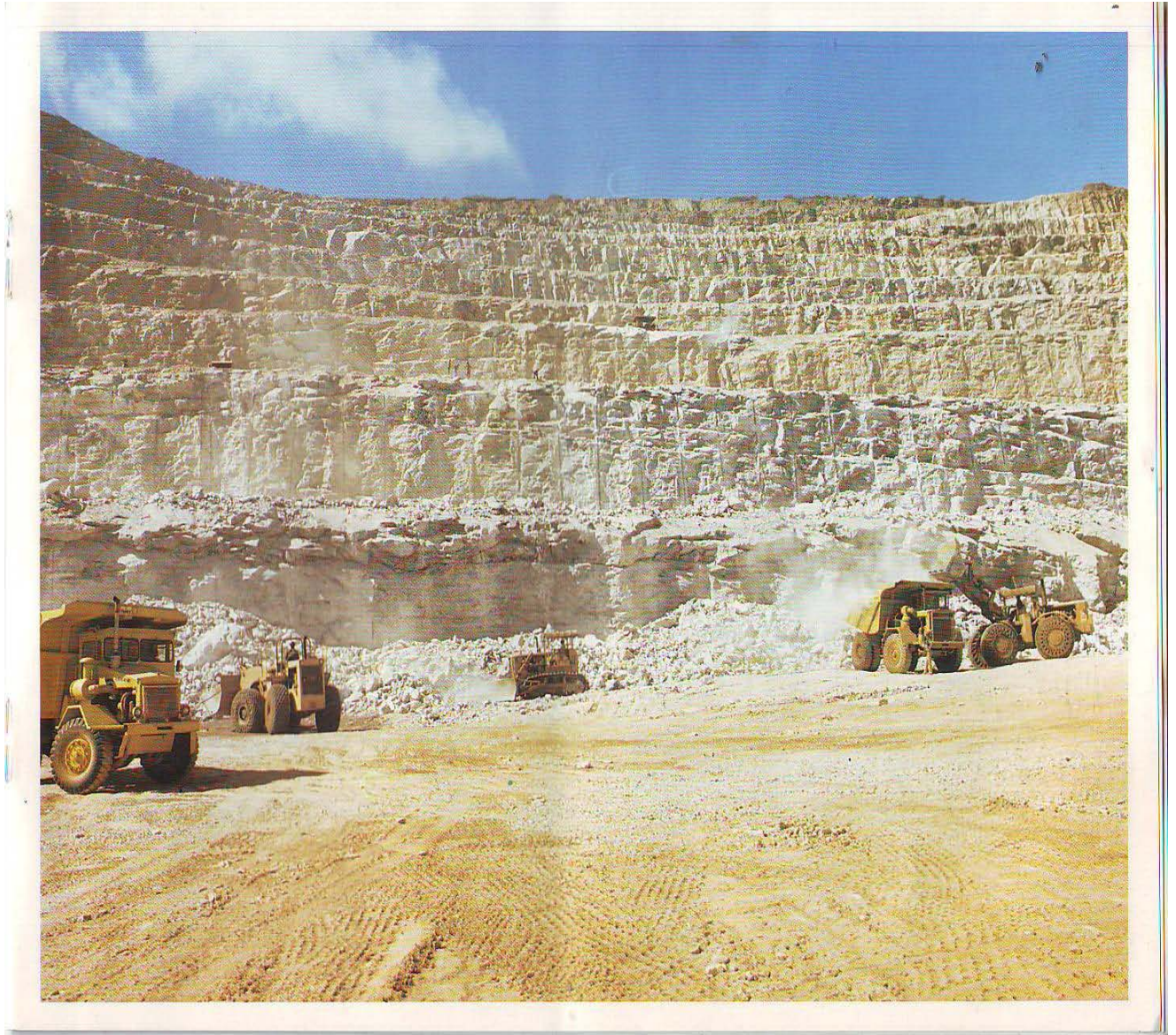
صورة تمثل مقالع الحجر في منطقة كبيسة / الانبار وتبين كيفية استغلال الحجر وبشكل مصاطب للسيطرة على نوعية المواد ومواصفاتها
