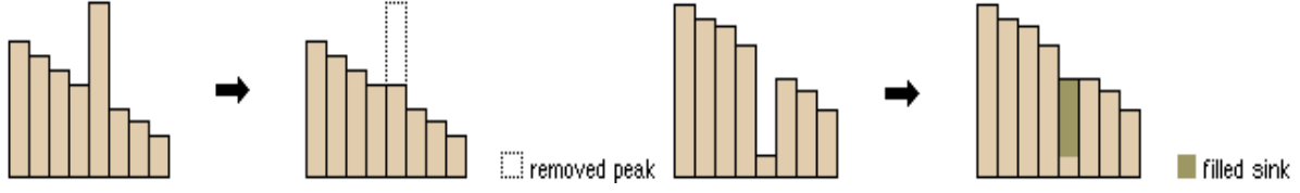
شكل رقم (2) تعديل قيم ملف الارتفاع الرقمي SRTM
