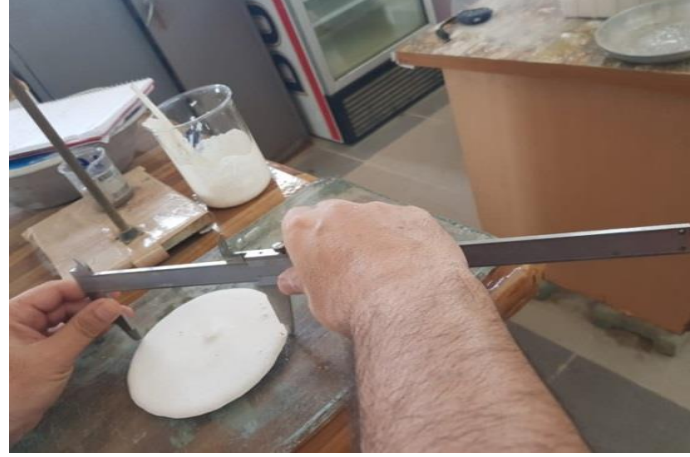
لوحة (4) قياس قطر الدائرتين من خلال أداة قياس (فيرنية)
