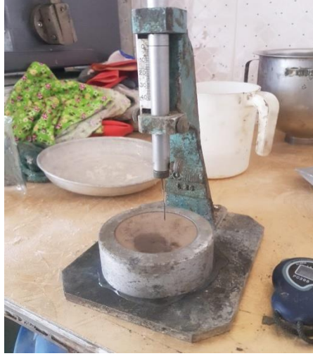
لوحة (5) ابرة جهاز فيكا لوحة (6) جهاز فيكا مع العينة
