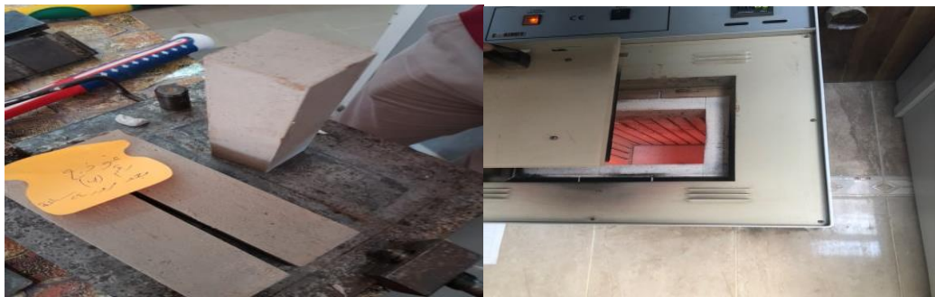
لوحة (7) مكعبات الجص خارج القوالب لوحة (8) يوضح فرن التجفيف
